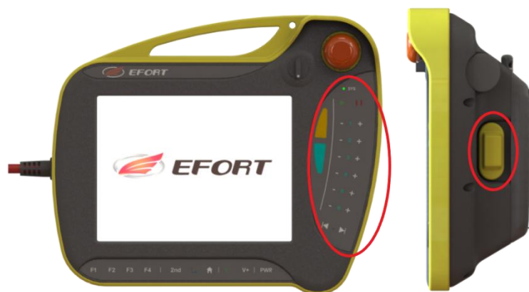
图 5-7 手压开关和点动按钮位置
