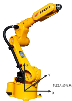
图 5-2 机器人坐标系图示
