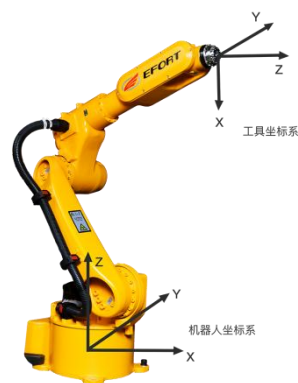
图 5-3 工具坐标系图示
