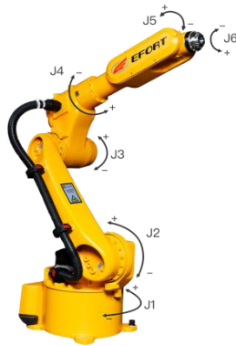
图 5-1 关节坐标系各关节轴运动角度图示
