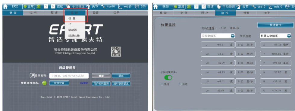
图 5-5 关节坐标系下位置监控界面
