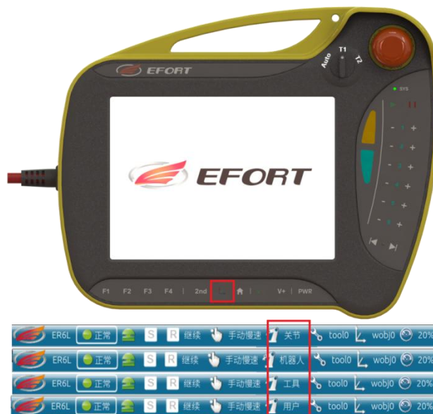
图 5-6 坐标系切换和不同坐标系图标
