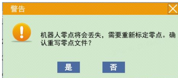
图 4.5.6-2 记录零位数据提示框图
