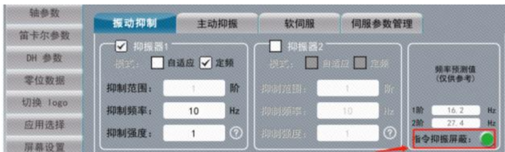
图 32-1 指令抑振屏蔽生效指示灯
