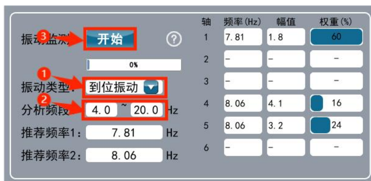
图 32.4.1.5-1 振动监测界面操作步骤
