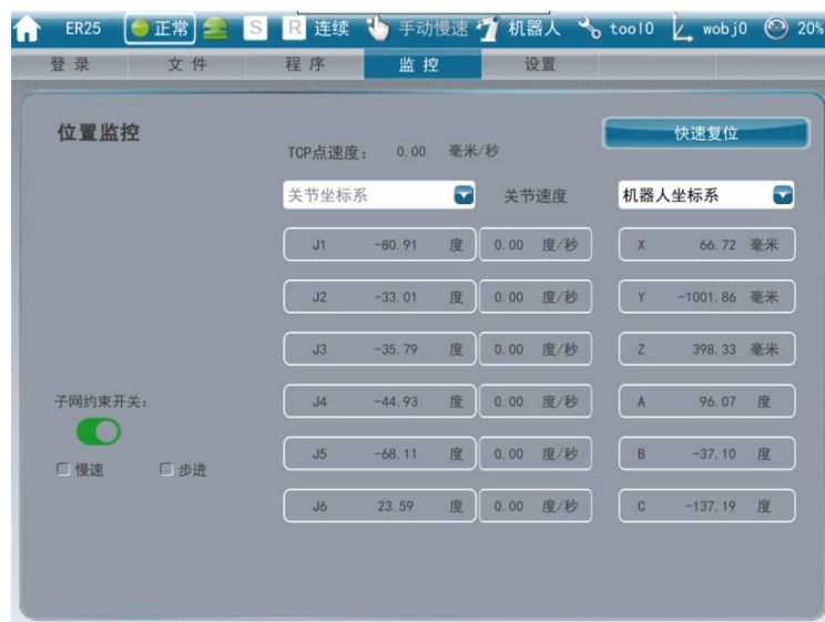
图 5-8 机器人坐标系下位置监控界面
