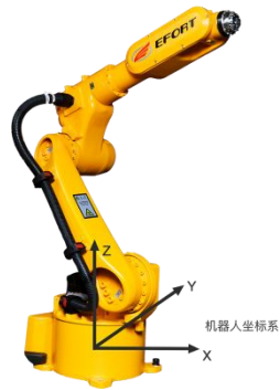
图 5-2 机器人坐标系图示
