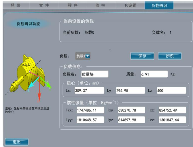
图 17.5.5-2 输入负载参数示意图
