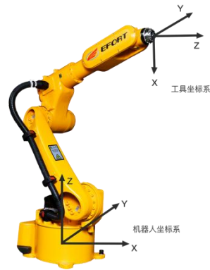
图 5-3 工具坐标系图示
