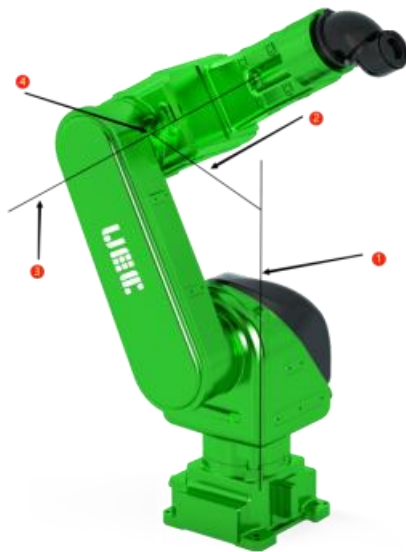
图 11. 3. 4. .1 正交腕机器人肘部圆球描述
