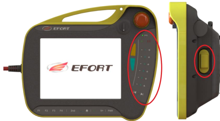
图 5-7 手压开关和点动按钮位置
