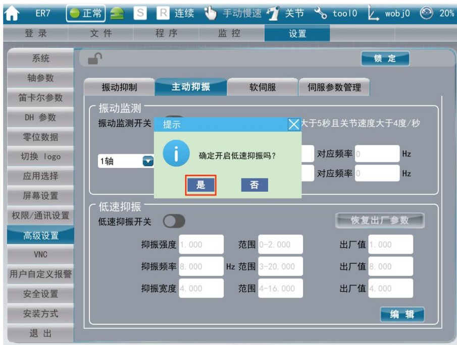
图 32.4.2.2.3-2 开启低速抑振开关
