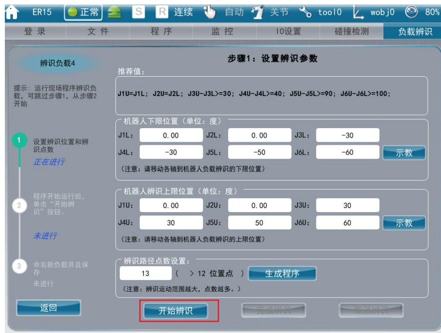
图 17.5.4.2-2 简易负载辨识操作步骤 2 示意图 1
