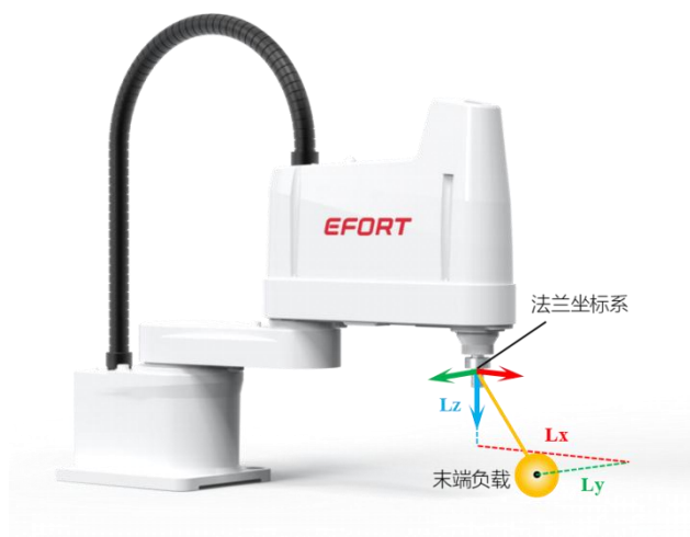
图 17.1- 3 SCARA 机器人负载及参考坐标系示意图
