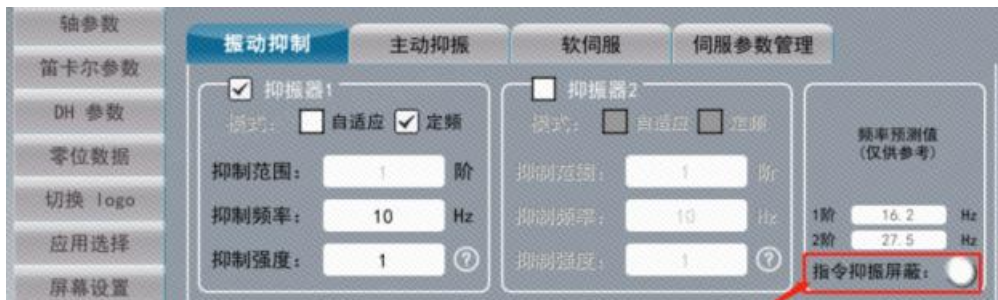
图 32-2 指令抑振屏蔽复位指示灯
