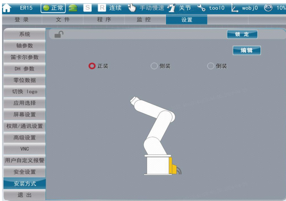
图 4.5.15.1-1 安装方式界面示意图
