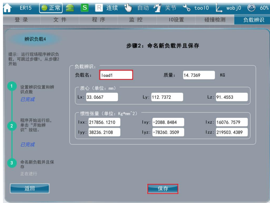
图 17.5.4.2-3 简易负载辨识操作步骤2 示意图
