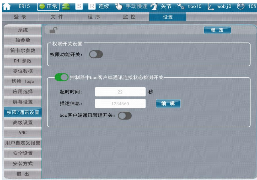
图 4.5.10.2-2 控制器中 bcc 客户端通讯连接状态检测开关打开
