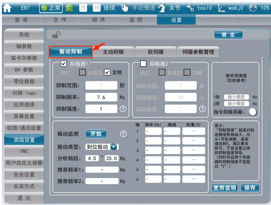
图 32.4.1.1-4 振动抑制功能界面
