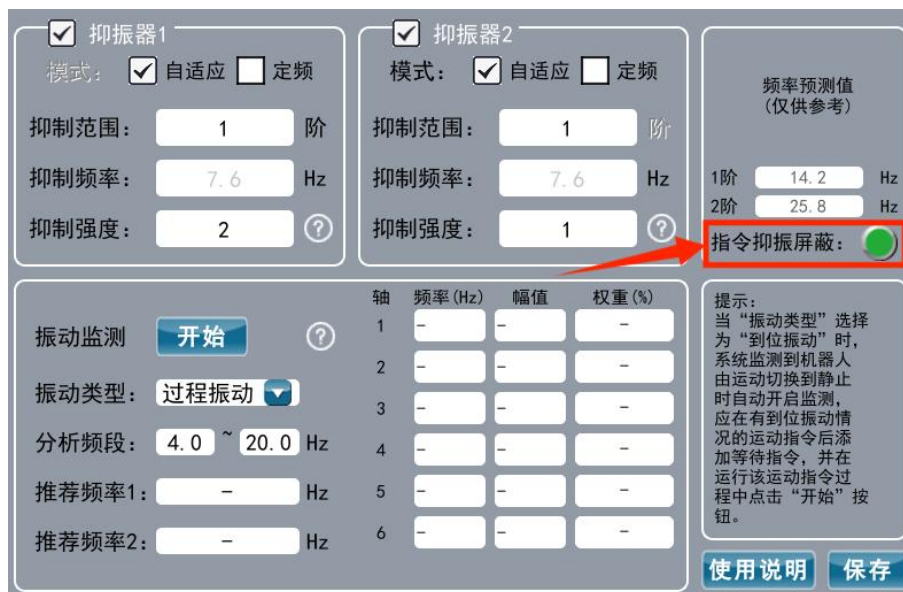
图 32.4.1.6-1 指令抑振屏蔽状态提示
