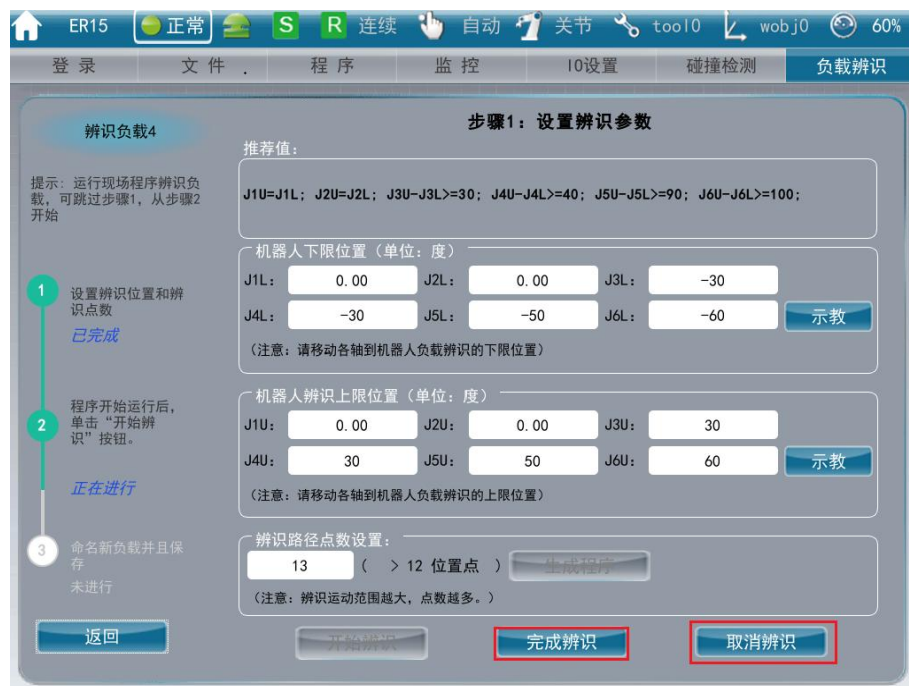
图 17.5.4.2-3 简易负载辨识操作步骤 2 示意图 2
