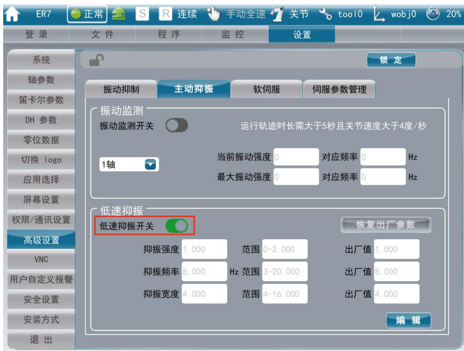
图 32.4.2.2.3-3 开启低速抑振开关
