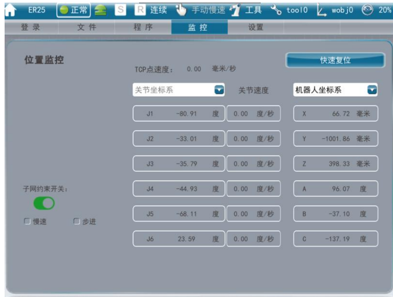
图 5-9 工具坐标系下位置监控界面
