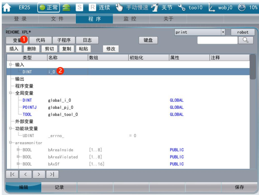
图 7.7.2.1.2-2 程序的输入变量
