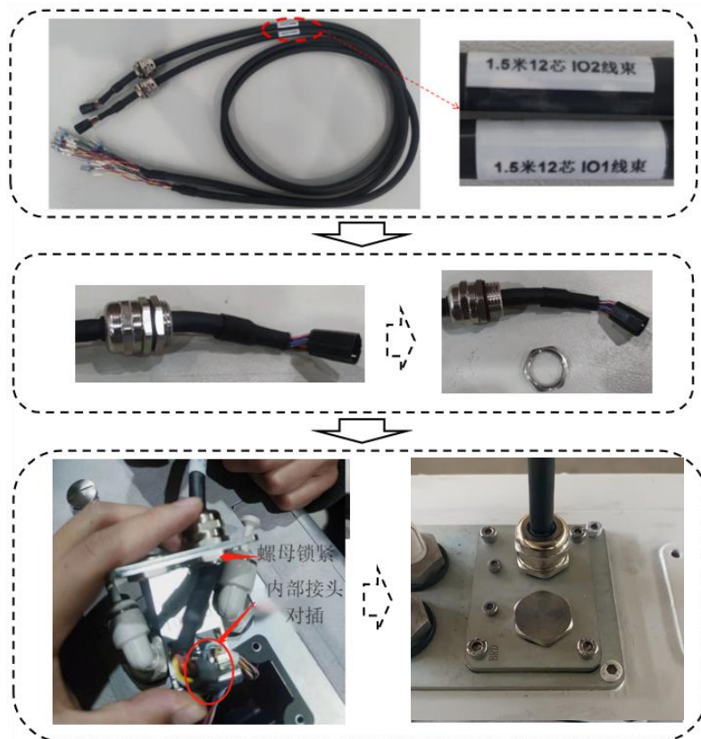
图 3-15 IO 锁头安装示意图
