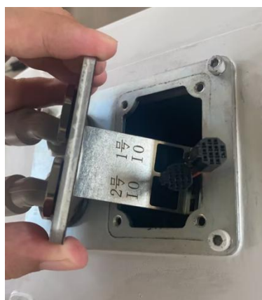
图 3-16 I/O 支架示意图
