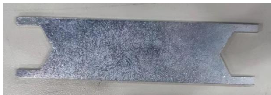
a. 小臂 I0 信号线安装扳手
