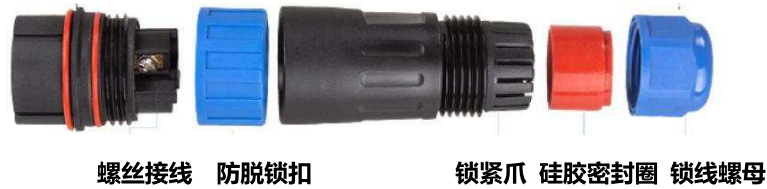
图 4.2.2 连接器拆解图
