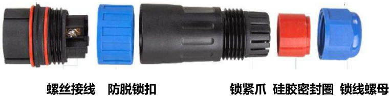
图 4.2.2 连接器拆解图
