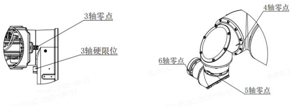
图 2-4 机械硬限位位置及零标位置
