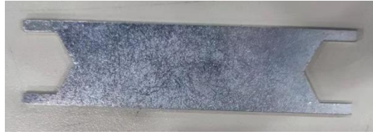
a. 小臂 I0 信号线安装扳手
